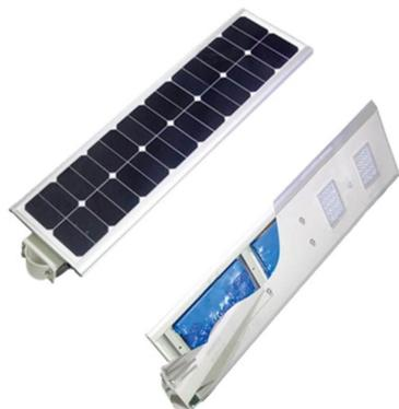
Gama de **luminarias solares LED inteligentes y autónomas**, en las que se integra panel fotovoltaico, batería de ión-litio de alta capacidad, controlador de carga y grupo óptico LED. Se incluye además un Sensor de presencia por infrarrojos para aumentar la autonomía, al reducir el nivel de iluminación al 30% cuando no detecta presencia.
